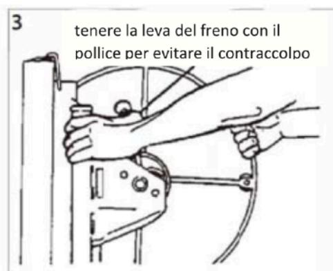
Ruotare la ruota leggermente in avanti mentre si solleva la leva del freno per rilasciare il freno. Sollevare la leva del freno fino in fondo. Afferrare il puntone dal paranco e tenere la leva del freno con il pollice. (Vedi figura 3).
