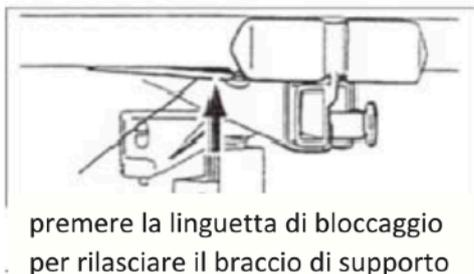
premere la linguetta di bloccaggio per rilasciare il braccio di supporto
